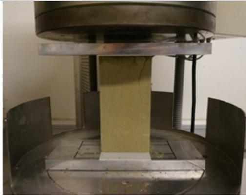
*Mesure de la résistance en compression de brique de terre crue.*
