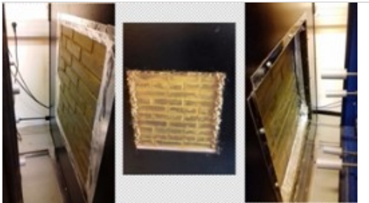
Test d'échanges hygrothermiques à travers une paroi de briques de terre crue compressée.
