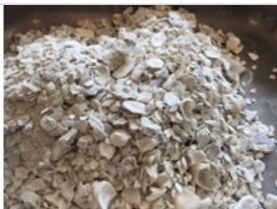
Coquilles d'huîtres concassées pour incorporation comme granulats dans du béton
