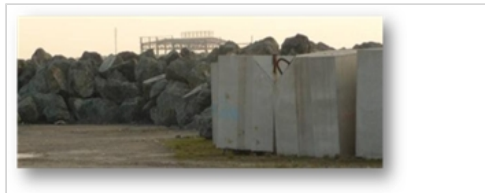
Formulation de béton lourd pour blocs d'encrochement avec des laitiers d'aciérie
