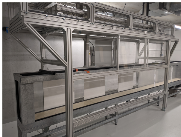
FIGURE 1 – Canal à lâcher de barrage du laboratoire SIAME.
